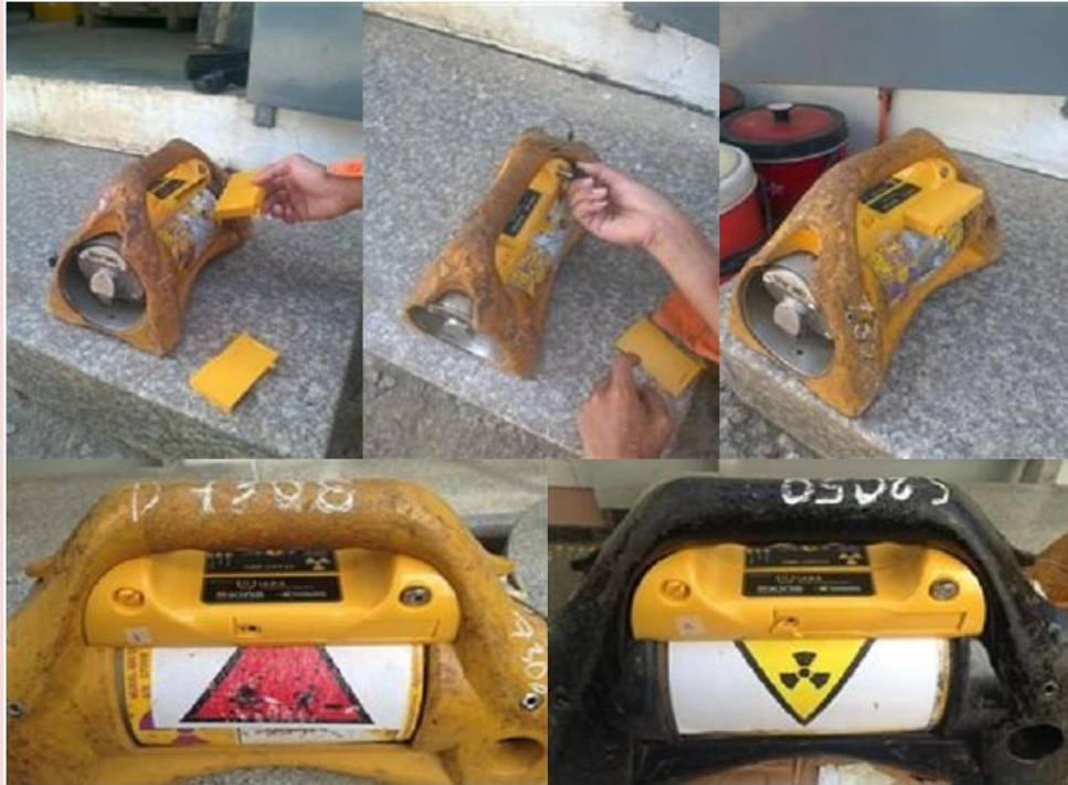
Hình 3. Các thiết bị định vị được lắp trên công ten nơ nguồn
