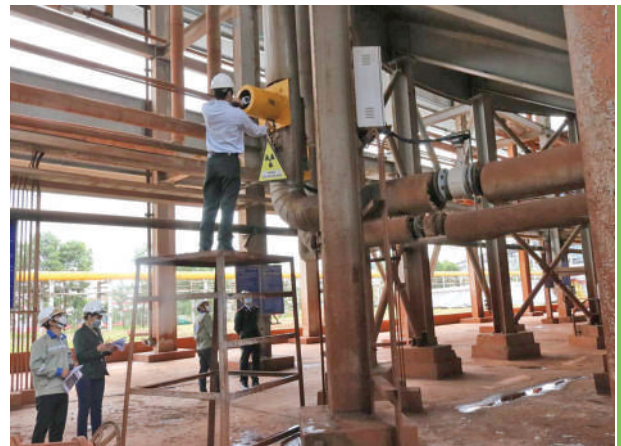
Đoàn thanh tra chuyên ngành về ATBX tiến hành đo, đánh giá an toàn khu vực lắp đặt nguồn phóng xạ
